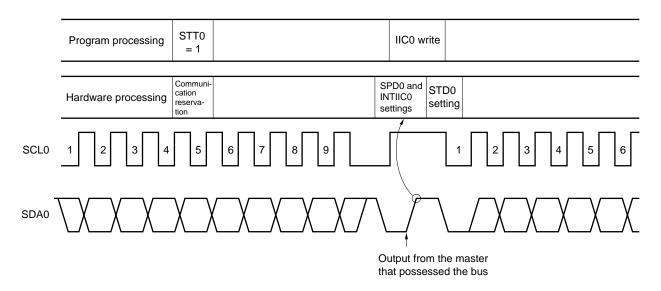
IIC0 : Serial shift register
